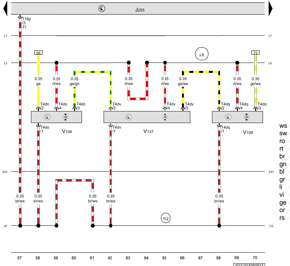
Climatronic 控制单元, 左侧脚部空间风门伺服马达, 右后温度风门伺服
