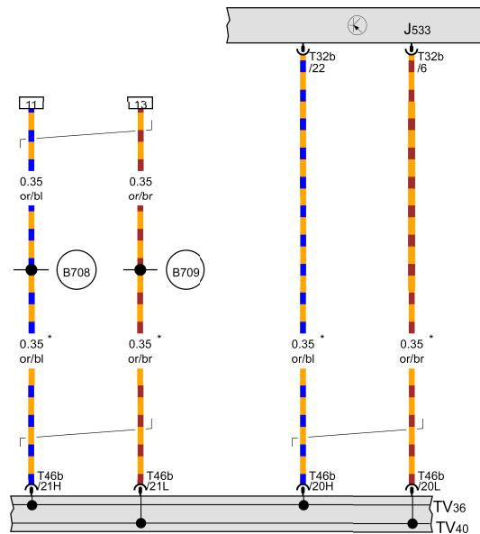
数据总线诊断接口, 仪表板 CAN 总线 (High) 导线分线器
