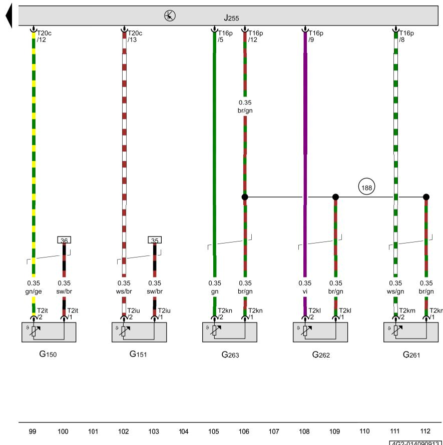
左侧出风口温度传感器, 右侧出风口温度传感器, 左侧脚部空间出风口温度传感器, 右侧脚部空间出风口温度传感器, 蒸发器出风口温度传感器,
