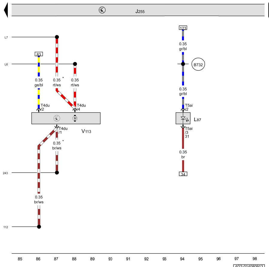
**Climatronic 控制单元, 后座中间出风口照明灯, 车内空气循环风门伺服马达**
