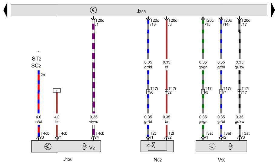
新鲜空气鼓风机控制单元, Climatronic 控制单元, 冷却液断流阀, 新鲜空气鼓风机, 冷却液循环泵
